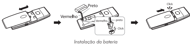
Instalação da bateria
